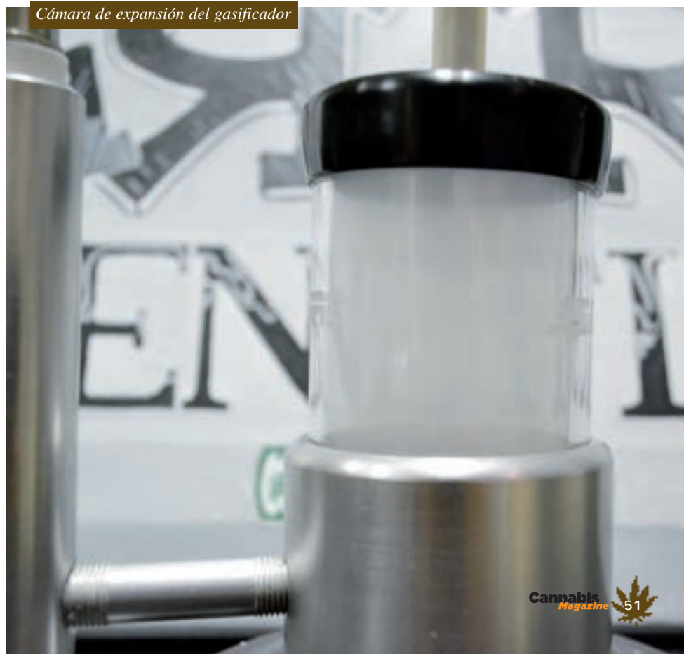
Cámara de expansión del gasificador
