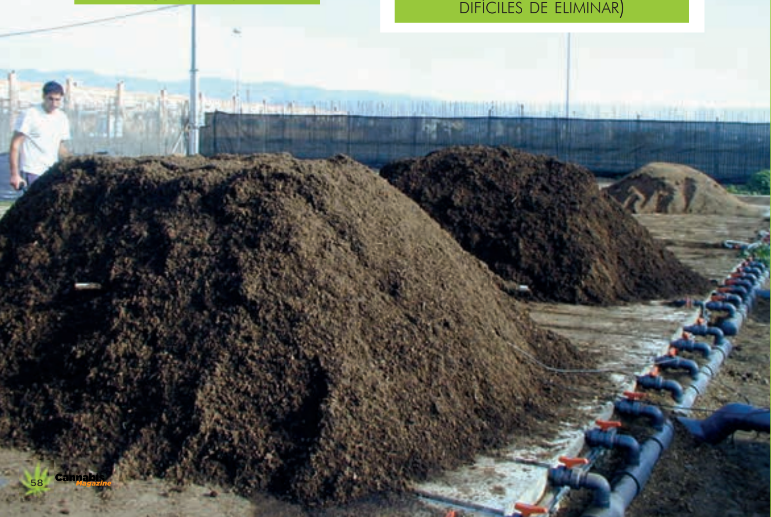
Proceso de compostaje con recogida de lixiviados
