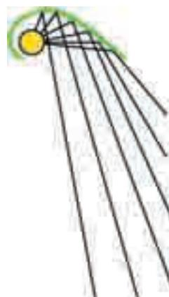
Por último, en la figura 5 se muestra el clásico espejo asimétrico. Estos reflectores tienen la propiedad de dirigir los haces de luz hacia una sola mitad del hemisferio inferior. Se los utiliza fundamentalmente en todos aquellos casos donde se desee iluminar intensamente una superficie vertical ( Wall washing, góndolas, etc... ). Ideal para suplementar plantas altas.
